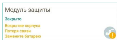
Рисунок 11.4 – Плашка модуля (корпус вскрыт, потеря связи, батареи разряжены)
